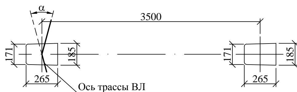
Схема установки стойки СВ95-3 (СВ95-2с, СВ95-3с)
