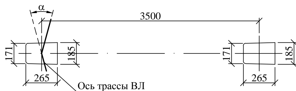
Схема установки стойки СВ95-3 (СВ95-3с)
